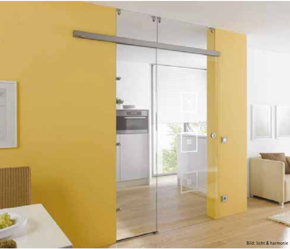
Schiebesystem 5801 18 mit feststehendem Seitenteil, mit Punkthalter, raumhoch, Schiene Tvin 2.0/120 ähnl. Edelstahl matt, Glas 8 mm-ESG Motiv matt/Fläche klar, Muschelgriff M70, ähnl. Edelstahl matt, bis 200 cm Gesamtbreite, Tür 93,5 x 205,8 cm
