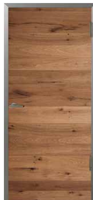
Glatte Tür 4606 18 Echtholz furniert FACHWERK Eiche Bronze quer, Türblatt stumpf, Röhrenspan, Alu-Zarge wandbündig, VX-Bänder, Spiegelbreite 40/52
