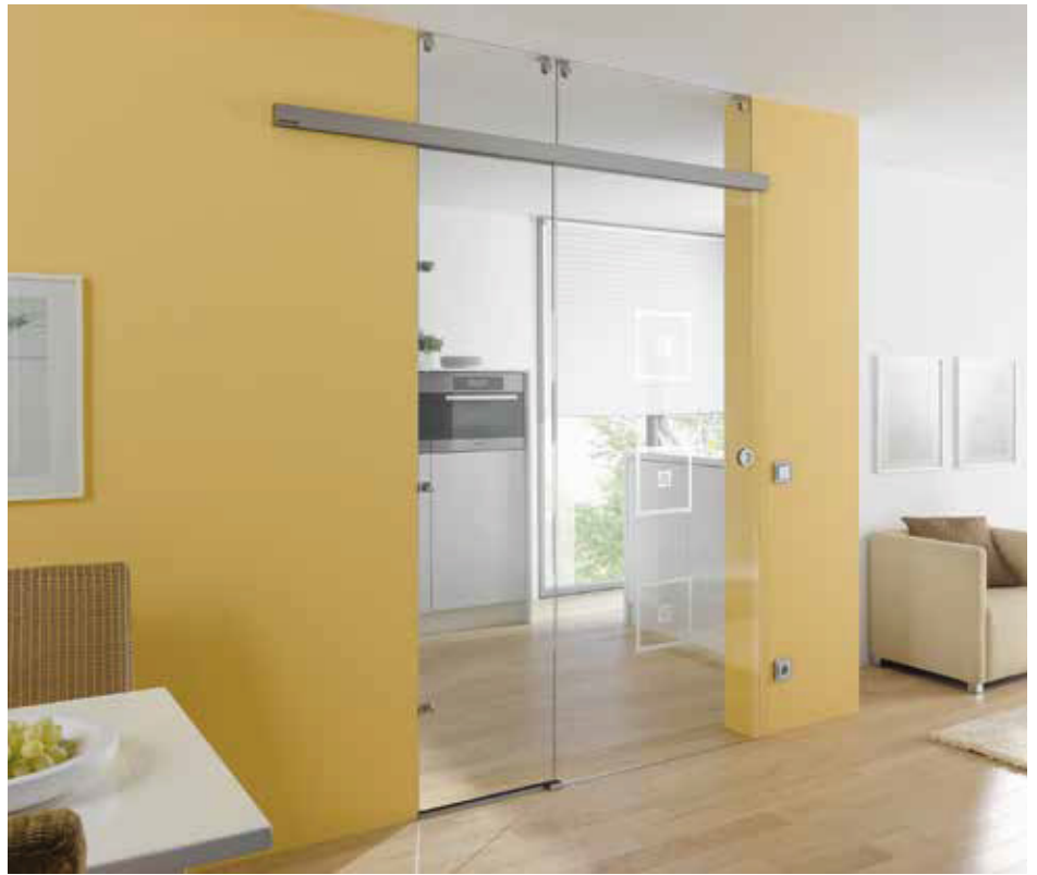
Schiebesystem 58 01 18 mit feststehendem Seitenteil und Oberlicht, mit Punkthalter, raumhoch, Schiene Tvin 2.0/120 ähnl. Edelstahl matt, Glas 8 mm-ESG Motiv matt/Fläche klar, Muschelgriff M70, ähnl. Edelstahl matt, bis 200 cm Gesamtbreite, Tür 93,5 x 205,8 cm
