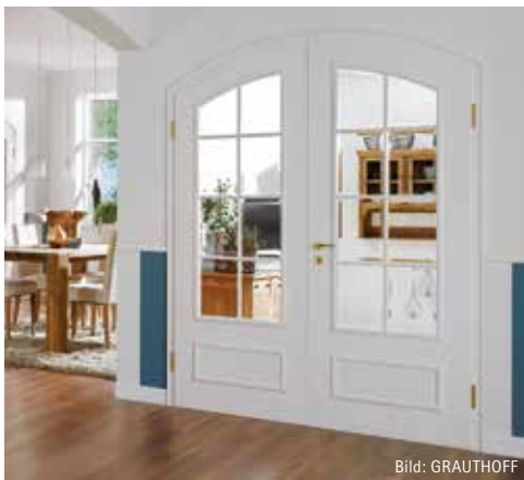
z. B. Stiltür, Stichbogen, zweiflg., Weißlack, Lichtausschnitt mit Sprossenrahmen, Zarge mit FZL Typ B
