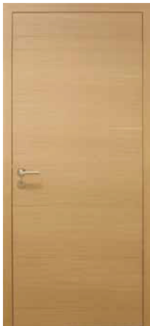
Glatte Tür 4504 18 Eiche Naturmatt, Quer-Furnier, Türblatt stumpf, verdeckte Tectusbänder, Röhrenspan, Zarge mit eckiger Kante
