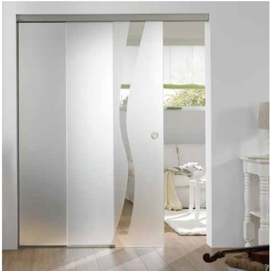
Schiebesystem 58 02 18 mit feststehendem Seitenteil, Schiene Tvin 2.0/120 ähnl. Edelstahl matt, Sturz-/Deckenmontage, Glas 8 mm-ESG Motiv klar/Fläche matt, STC, Muschelgriff M70, ähnl. Edelstahl matt bis 200 cm Gesamtbreite, Tür 110 x 215 cm
